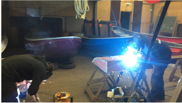
3 Het lassen van de diesel tanks
